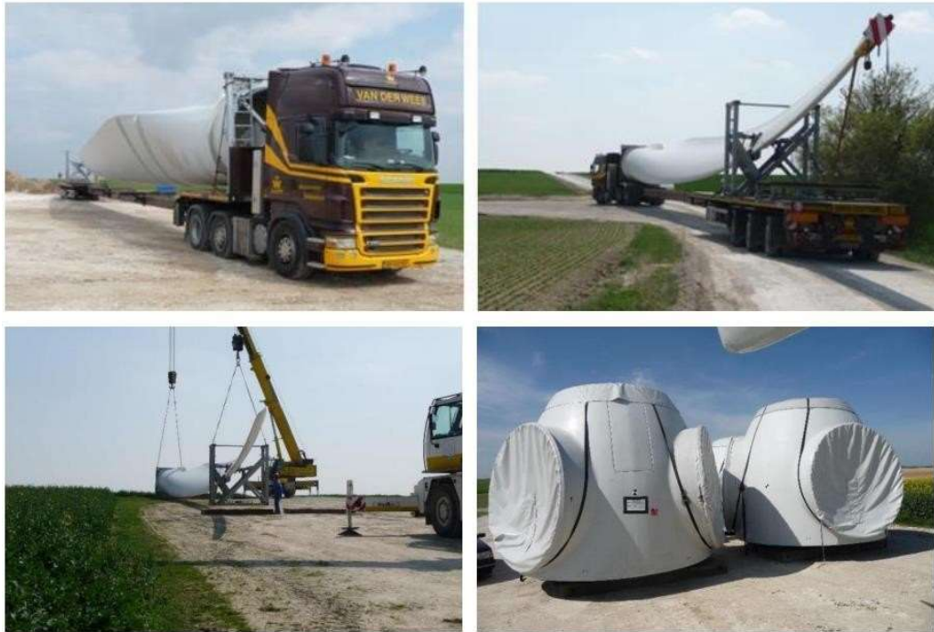
photographie de l'acheminement par camion des composants des éoliennes
